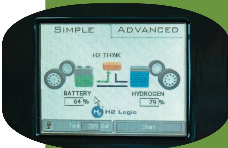
Nyttig information. Dette lille display fortæller, om bilen drives frem af el eller af brint, og om brinten oplader batteriet.
